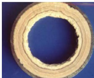
Fig. B1 -Capas de incrustación calcárea en el interior de una tubería de acero.
