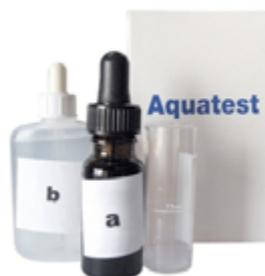
Fig. A2 -Determinación de la dureza del agua.
