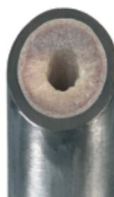
Fig. A1 -Capas de incrustación calcárea en el interior de una tubería de acero.
